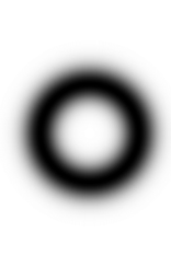
Slika 50: Gaussov pasovnozaporni filter velikosti 512 \times 512 , \sigma = 25 , \mu = 100
