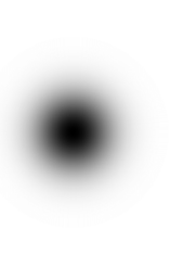
Slika 48: Gaussov visokoprepustni filter velikosti 512 \times 512 , \sigma = 55
